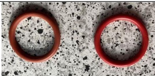
Abbildung 3: Farbbeispiel O-Ring FMQ
