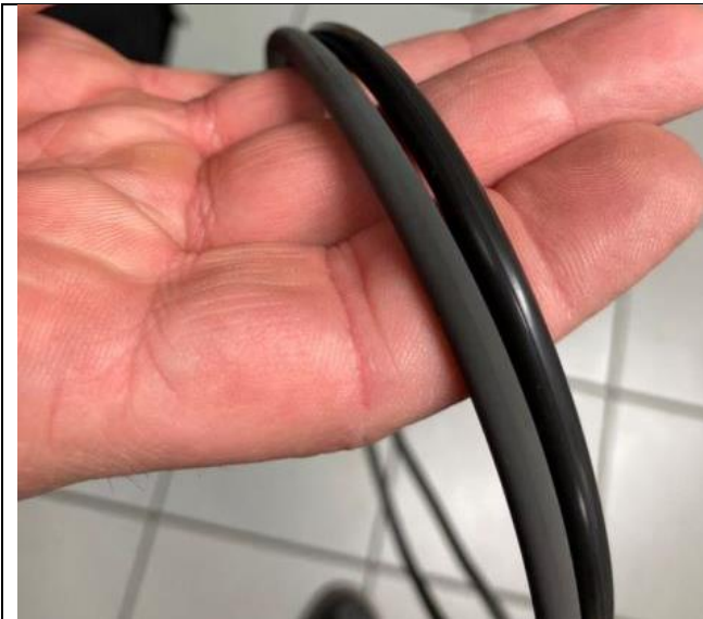
Abbildung 1: Farbbeispiel R-Ring NBR
